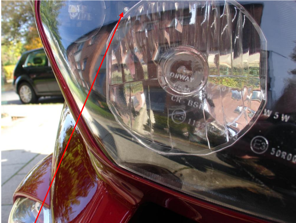
Bild 3: Oben links ist die Einstellschraube des Scheinwerfers zu sehen und wenn man sie mit einem Schraubendreher bewegt, dann sieht man auch wie sie sich bewegt. Zum besseren Verständnis habe ich davon mehrere Fotos gemacht! Siehe Bild 4, 5, und 6.
